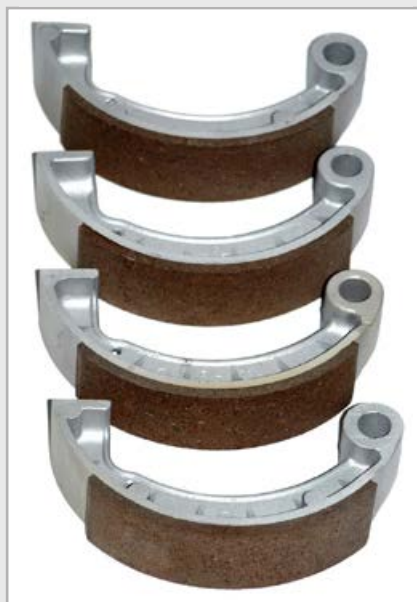
JAWA 250 – renovace brzdových čelistí
