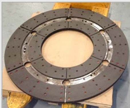
Třecí lamela lisu D945x24
