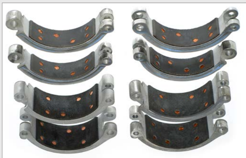
JAWA 500 OHV – aplikace třecích materiálů na nové brzdové čelisti
