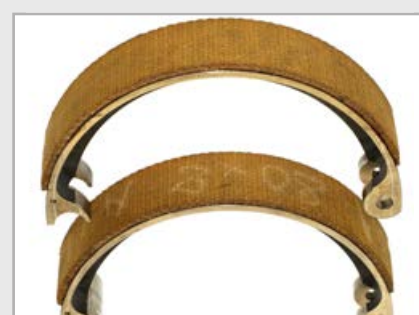
Brzdové čelisti podavače D510x80x8
