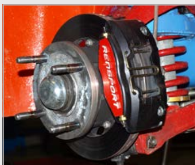
Brzdová soustava RENSPEED homologovaná do silničního provozu a pro Mistrovství České republiky pro skupinu HA, vozidla Škoda typy 100,110,110R,120,125,130,130RS,136L Rapid
