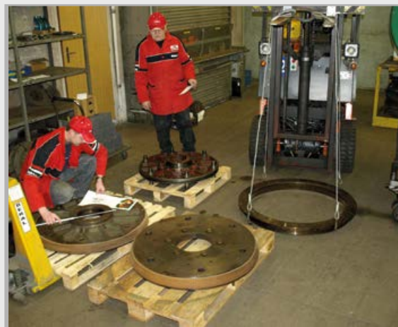
Kuželová spojka lisu D910x8 – výstupní kontrola
