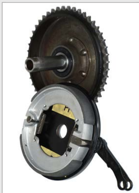
OGAR – renovace čelistové brzdy
