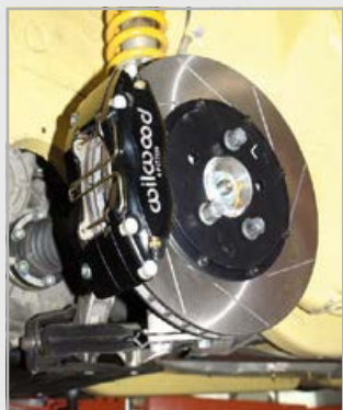
ŠKODA FABIA RS 1.9 TDI - brzdový kit pro přední nápravu, komponenty WILWOOD, RENSPEED
