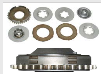
Renovace spojkového kitu NORTON H18
