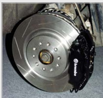
ŠKODA OCTAVIA RS 2.0 TFSI - brzdový kit pro přední nápravu, komponenty BREMBO RACING, FERODO
