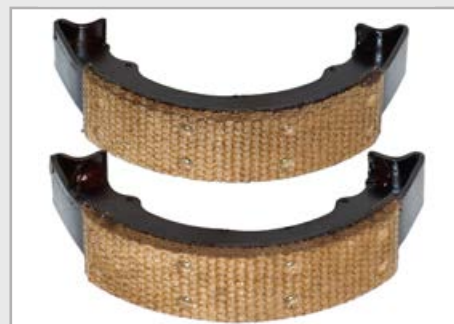
RUDGE RADICAL – renovace čelistové brzdy
