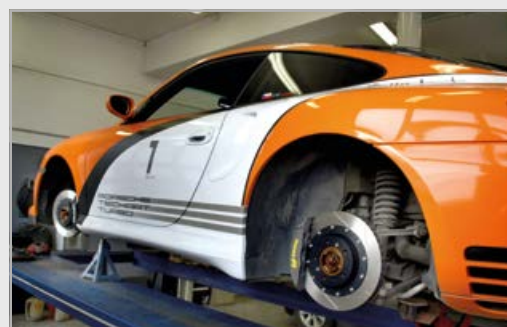
PORSCHE 911 996 - brzdový kit pro celé vozidlo, komponenty AP RACING, WILWOOD, RENSPEED
